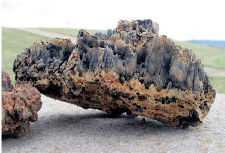
Extreme deponiespezifische Inkrustation (20 cm stark)
